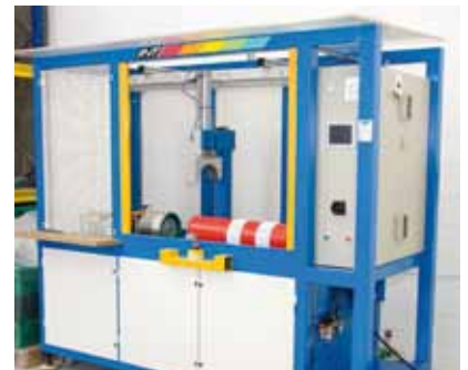
Integración de fuste y base por termofusión.
