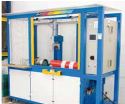
Integración de fuste y base por termofusión.
