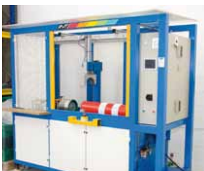
Integración de fuste y base por termofusión.
